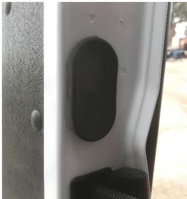
Figure 18: Remove Rubber Door Grommet
